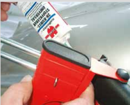
Sõltuvalt juhtumist kasuta üldkasutatavat 2K-plastiliimi või kiiret 2K-plastiliimi. Ühtlase 1:1 segu saamiseks pressi alguses välja 1-2 cm pikkune lint; alusta seejärel liimimistööd.
