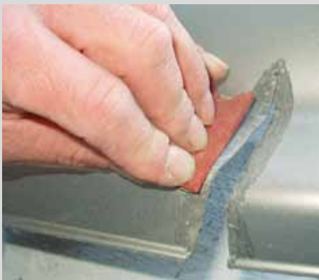
Lihvi parandatava koha esi- ja tagakülg P180 lihvpaperiga. Väldi lihvimiskoha tugevat kuumenemist.
