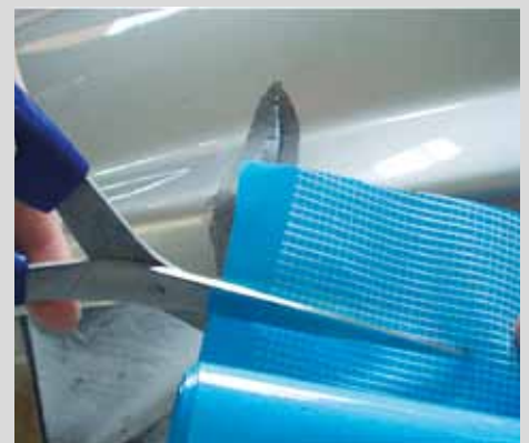
Lõika isekleepuv tugevduslint parandatava kohaga sobiva suurusega.
