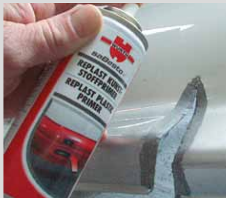
Pihusta õhuke kiht krunti ja lase kuivada 2 min. (+23°C).
